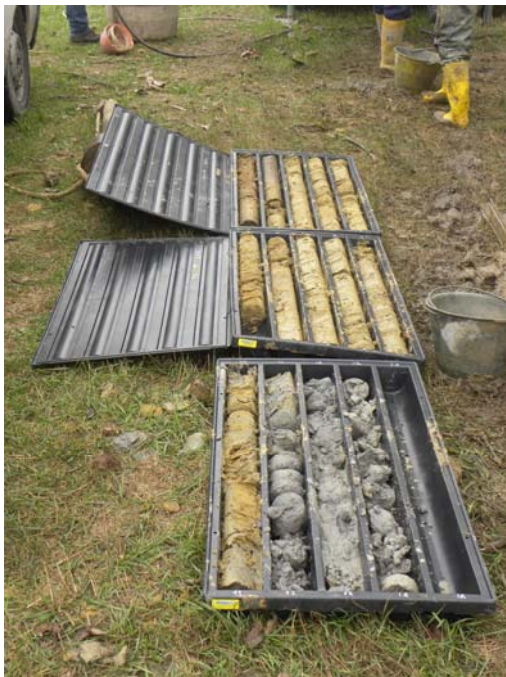
Foto 11: materiale estratto nel carotaggio continuo presso Via Monte di Pietà (Faenza)
