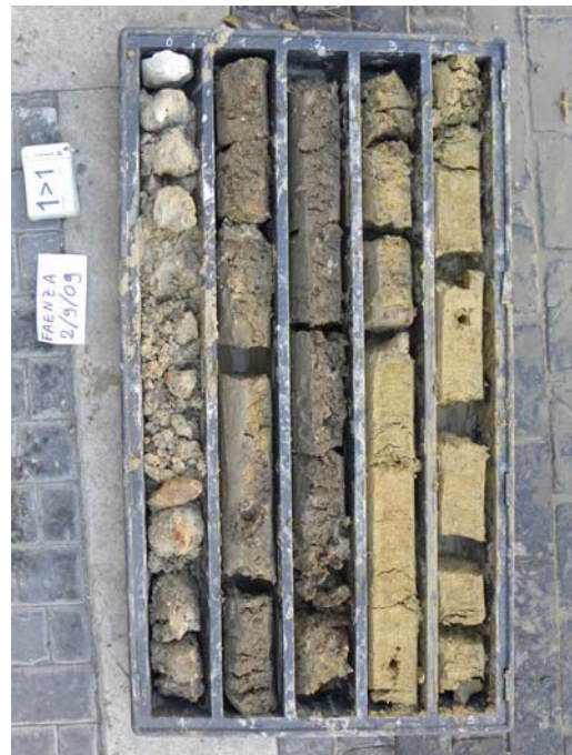
Foto 12: materiale estratto nel carotaggio continuo presso Piazza del Popolo (Faenza)
