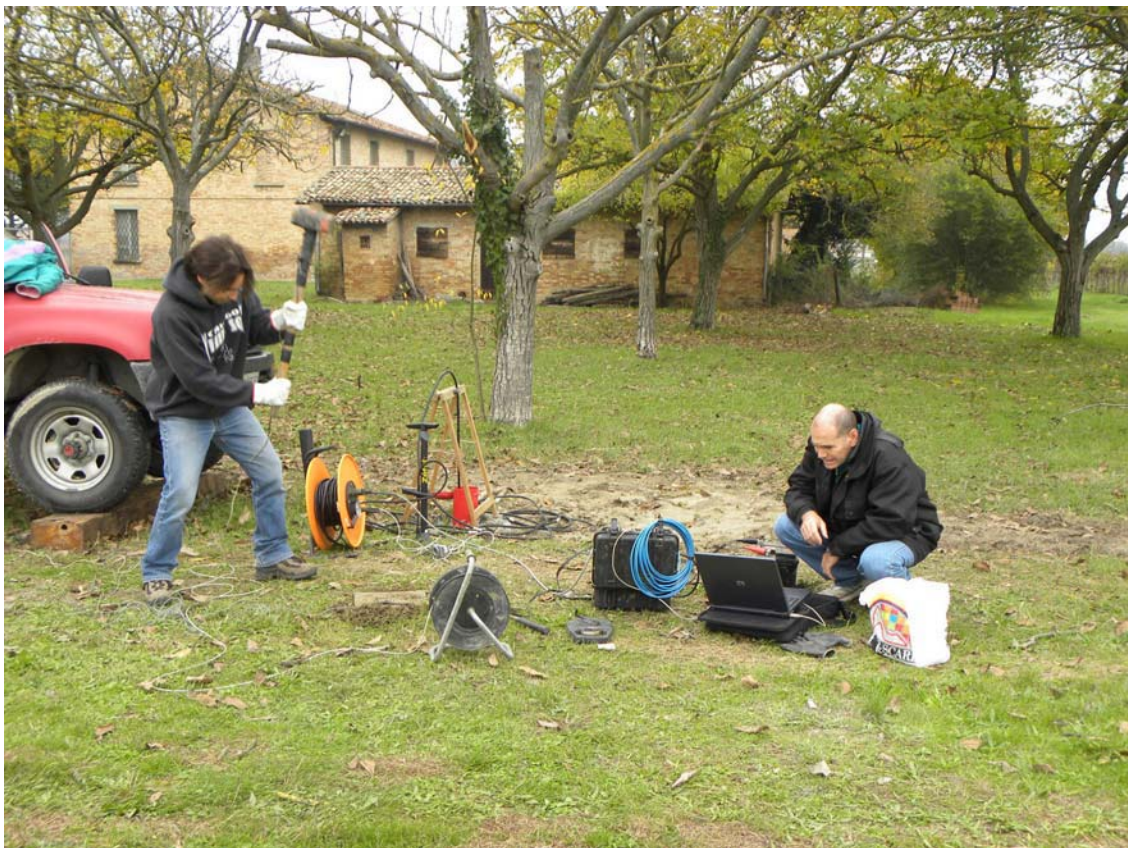
Foto 6: prova Down-Hole presso Via Monte di Pietà (Faenza)
