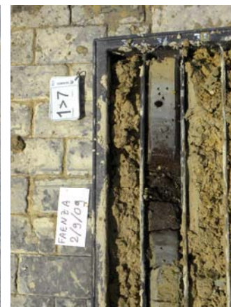
Foto 9: particolare materiale estratto con carotaggio continuo
